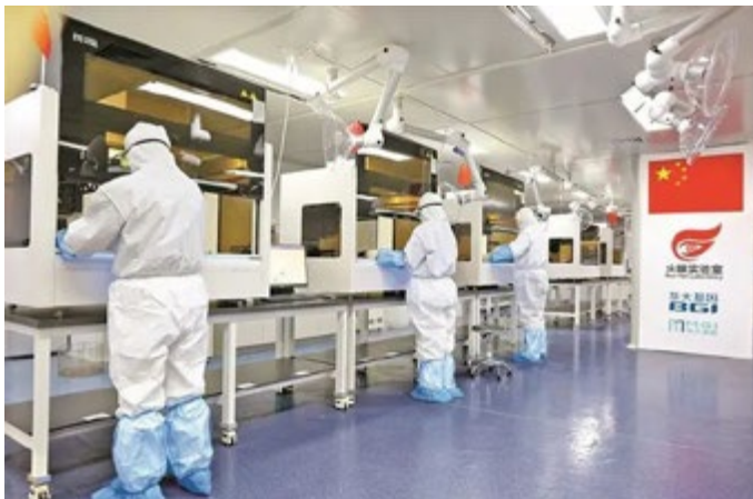
华大基因火眼实验室装备了华大智造高通量自动化病毒核酸提取设备，通量达到 192 样本 /80 分钟，一人可同时操作三台，相比人工提取有 50 倍的通量提升
